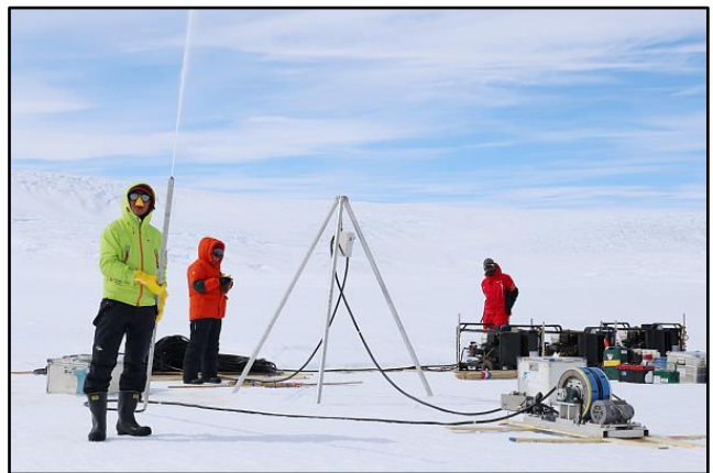
観測を行ったラングホブデ氷河と熱水掘削の様子
