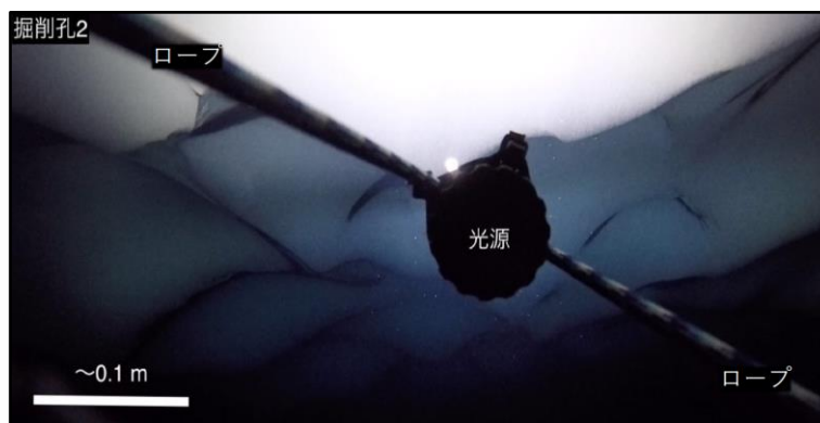
図 3. ビデオカメラによって撮影された棚氷底面の形状。氷の表面に融解を示す凹凸が確認できる。
